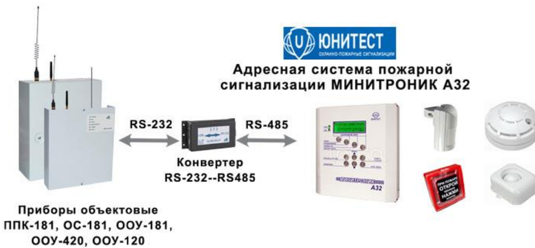
Рис. 8.6. Подключение АС «Минитроник А32» к системе «ОКО».
