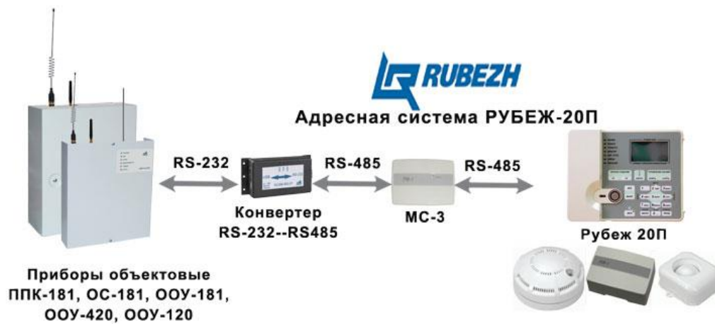
Рис 8.7. Подключение АС «Рубеж» к системе «ОКО».
